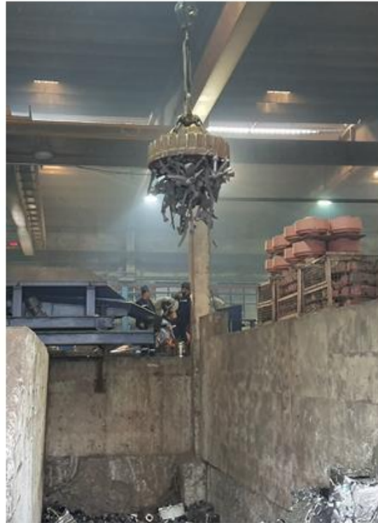
Uygulama fotoğrafı EK-10 elektromagnet ile alaşımli döküm malzemelerin potaya beslenme işlemi.
